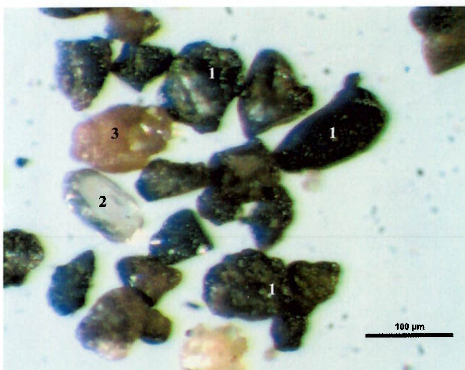
Figura 17 – Amostra: produto afundado, fração -0,297 mm. Aspecto de detalhe. Partículas liberadas de oxi-hidróxi de Fe (1) e zircão (2). Partícula mista de rutilo com zircão (3).
