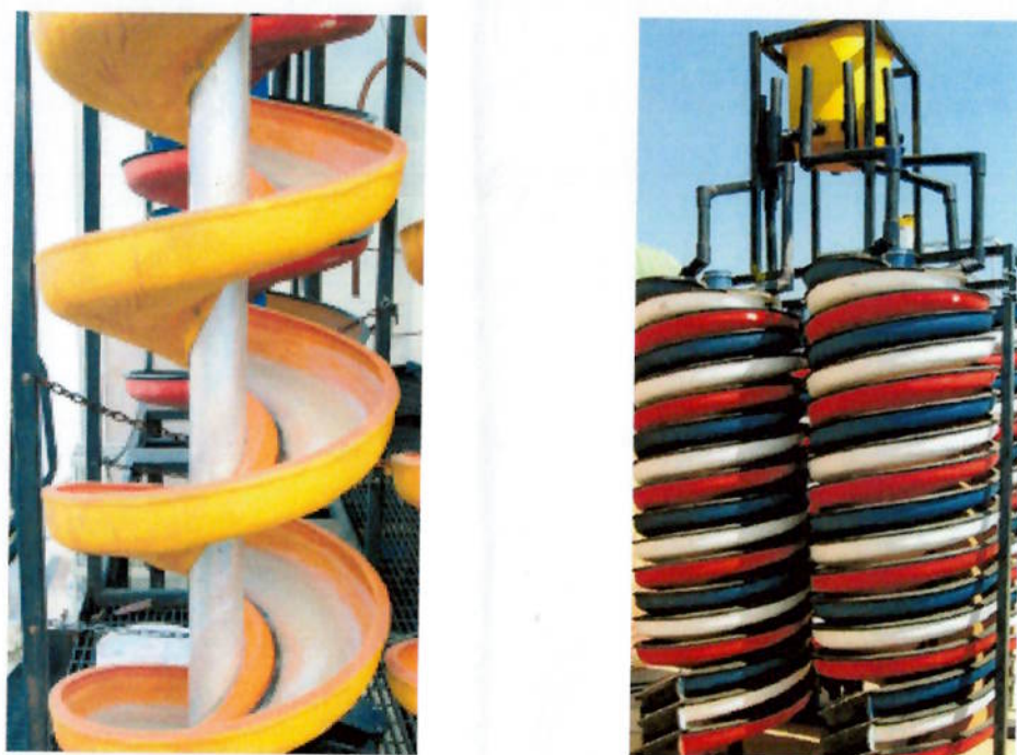
Figura 19 – Espiral concentradora simples (esquerda) e tripla (direita)
