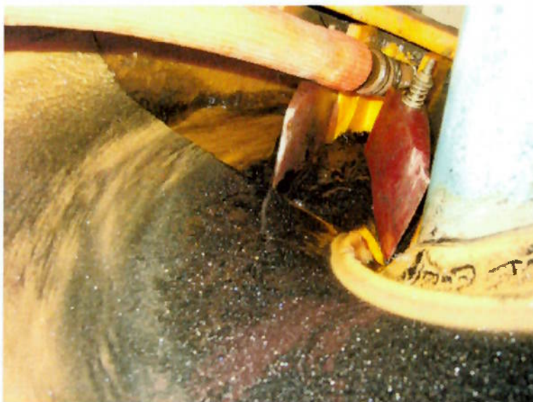
Figura 20 – Detalhe do desviador de fluxo de uma espiral concentradora
