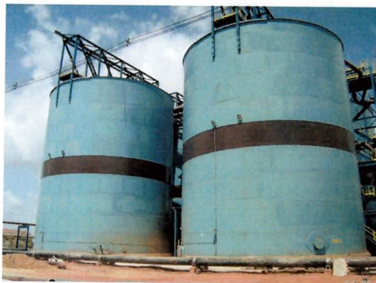
Figura 3 – Tanques de estocagem e homogeneização da polpa para posterior envio à Barcarena
