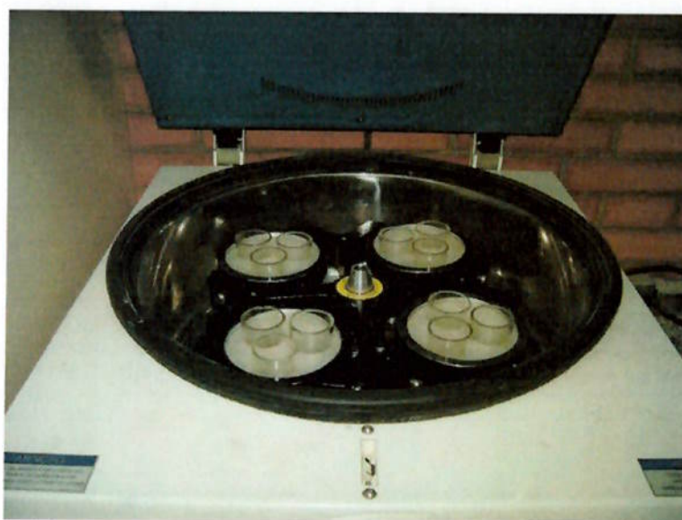
Figura 10 – Conjunto cilindros/frascos utilizados no ensaio de meio denso
